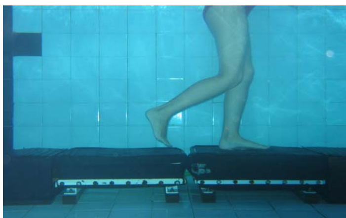
Figura 5 - Foto das plataformas de força subaquáticas desenvolvidas por Roesler (1997).
