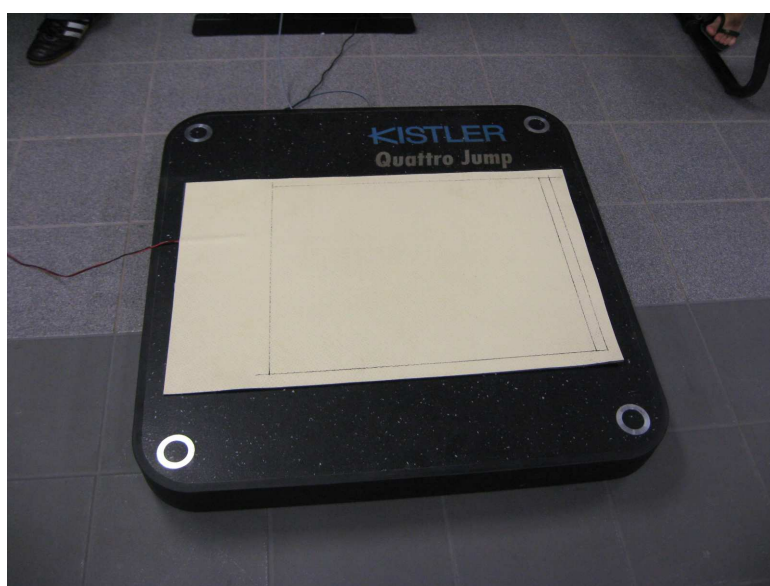
Figura 22 - Tapete do Sistema de Medição de Contato com o Solo sobre a plataforma Quattro Jump
