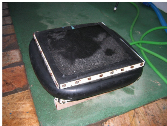
Fig. 9: Plataforma de Força construída por Roesler (1997) Laboratório de Biomecânica Aquática - UDESC
