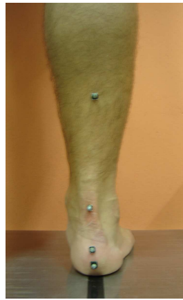
Figura 9: Posicionamento do pé para marcação dos marcadores reflexivos
