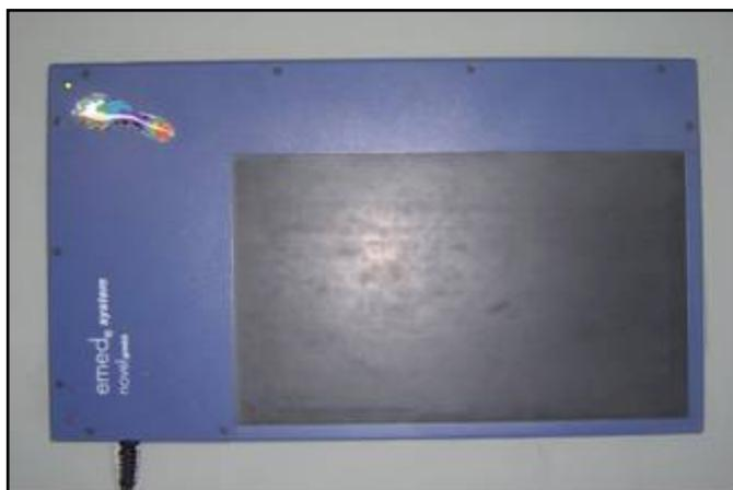
**Figura 2 – Plataforma capacitiva do Sistema *Emed (Novel, Gmbh)*.**
