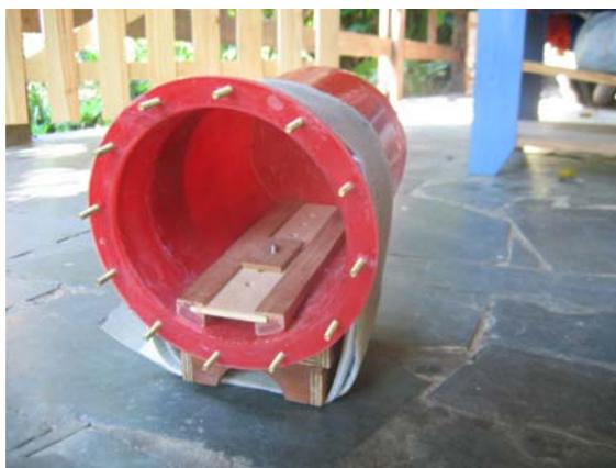
**FIGURA 24:** Caixa estanque cilíndrica.
