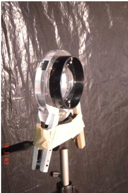
**FIGURA 20:** Visor da lente de vidro da caixa estanque comercial.
