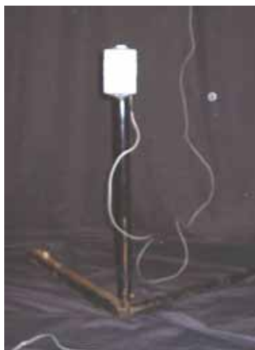
Figura 13- Imagens da fotocélula receptora, desenvolvida para este estudo, no suporte para ajuste de altura
