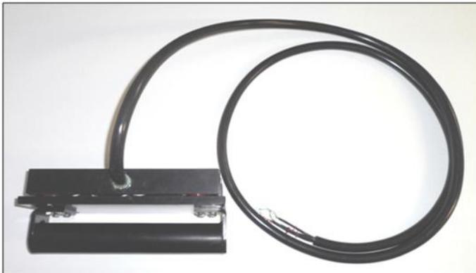
A Figura 16 apresenta a vista inferior da plataforma de força 1. Nesta podem ser visualizadas partes dos fios elétricos que constituíram as pontes de Wheatstone.
