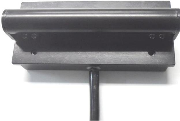
A Figura 15 apresenta a vista lateral da primeira plataforma de força construída para este estudo. Pode-se observar a inserção dos cabos elétricos isolados, por uma mangueira, na base metálica da plataforma.
