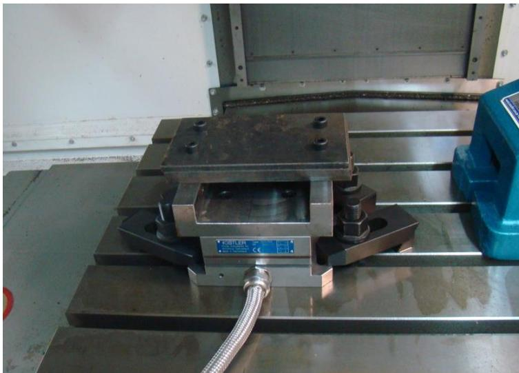
Durante o ensaio os eixos  $x$ ,  $y$  e  $z$  do dinamômetro foram alinhados com os da máquina, o que possibilita, através das medidas das componentes de força nas direções  $x$ ,  $y$  e  $z$ , a determinação da força tangencial ( $F_t$ ), força radial ( $F_r$ ) e força axial ( $F_a$ ).
