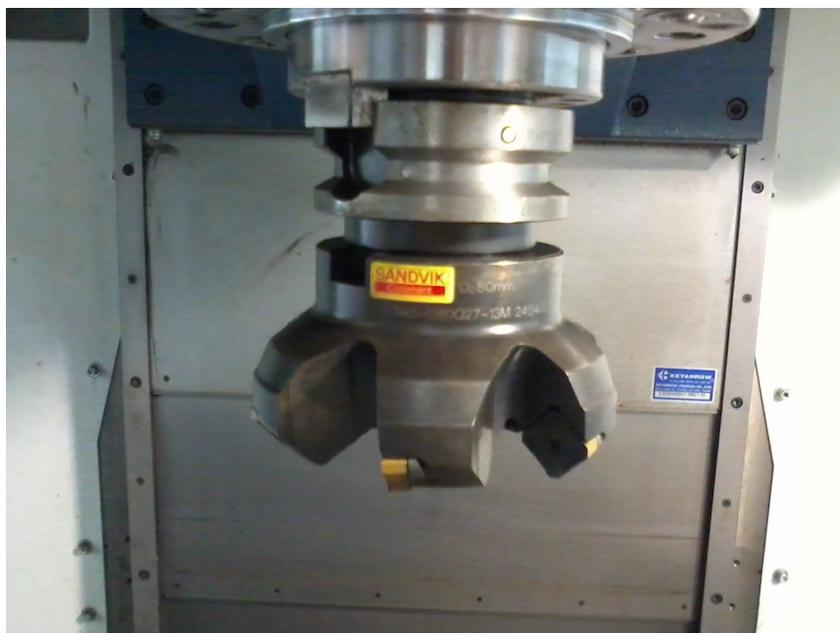
Durante o fresamento do ferro fundido cinzento, os sinais da força de usinagem em cada direção  $F_x$ ,  $F_y$  e  $F_z$  e os sinais de aceleração foram adquiridos para comprovar o surgimento ou não da vibração regenerativa. A Figura 36 mostra o processo de aquisição de sinais.
