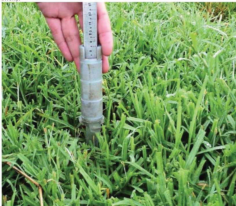
Figura 5 – Detalhe da medida de altura com bastão graduado em cm ( sward stick ).
