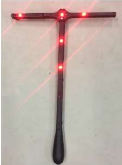
Figura 3 – Calibrador do Vicon Bonita MX®.
