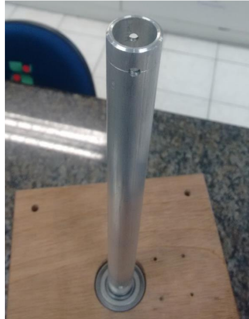
Figura 11: Cavidade superior para encaixe da haste horizontal
