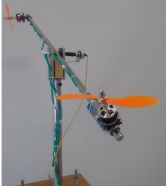
Figura 12: Inclinação do motor de arfagem
