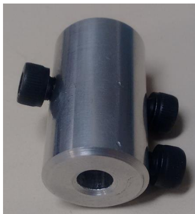
Figura 13: Bucha de acoplamento para o sensor de arfagem
