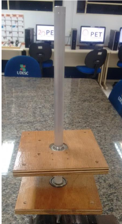
Figura 10: Nova base e eixo vertical da planta
