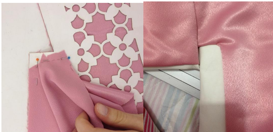
Figura 63: Costura do forro lateral da frente pique e resultado final.
