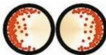
Figura 2-Efeito de proximidade em dois condutores elétricos
